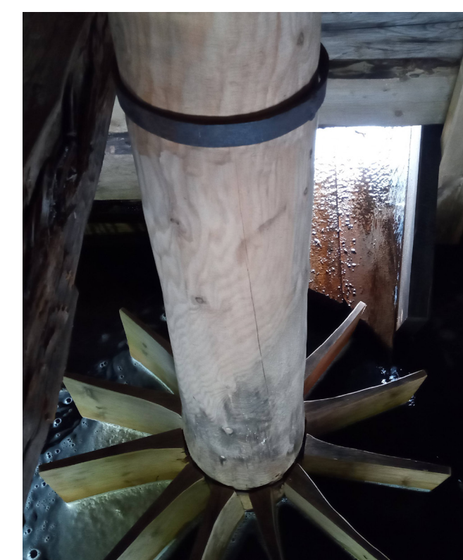
Skovelhjulet i en kvarn vid Torvsjö kvarnar. Foto: Mats Pleje 2024.
